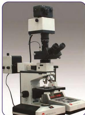
دستگاه میکروسکوپ نتالوگرافی
