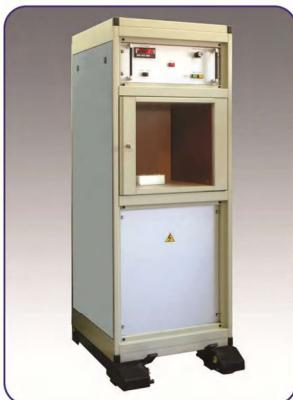
دستگاه سنجش ولتاژ فروپاشی عایق
